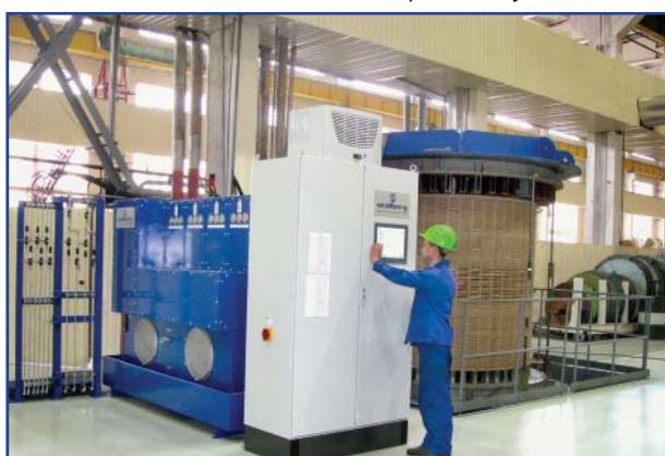
Стабилизирующая система для прессовки обмоток
