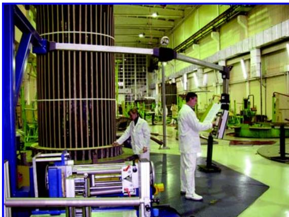
Участок микроклимата представляет собой пространство, отгороженное от основного цеха прозрачной перегородкой. Вход на участок предусматривается только в специальной одежде через специальный тамбур. Внутри участка обмотки будут перемещаться при помощи крана и платформы на воздушной подушке. Перемещение обмоток, комплектующих и оснастки с участка на участок будет осуществляться на платформе на воздушной подушке.
